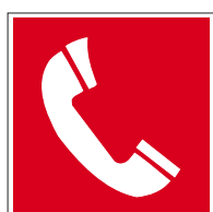
Pic. 402 Telefoon voor brandalarm
