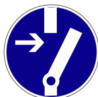
Pic. 278 Schakelen voor ingebruikname
