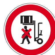
Pic. 215 Niet onder opgetilde lasten staan
