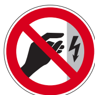
Pic. 220 Niet aanraken, behuizing onder spanning
