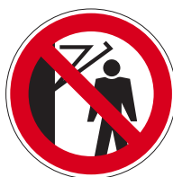
Pic. 602 Verboden onder de hendel te lopen
