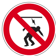
Pic. 231 Aanraken van sterkstroomkabel verboden
